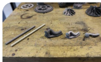
> Les différents étapes du procédé BMD : impression à partir d'un mélange polymère / poudre métallique, déliantage et frittage, retrait des supports et finition
